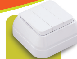
451A5 Üçlü Anahtar 3 Tuşlu (1+3) 1 Giriş, 3 Çıkış Triple Switch 3 Button (1+3) Gerilim/Rated Voltage 250 V~ Akım/Rated Current 10 AX Koruma Derecesi/Protection IP20
