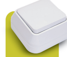
451A7 Üçlü Anahtar Tek Tuşlu (1+3) 1 Giriş, 3 Çıkış Triple Switch Single Button (1+3) Gerilim/Rated Voltage 250 V~ Akım/Rated Current 10 AX Koruma Derecesi/Protection IP20
