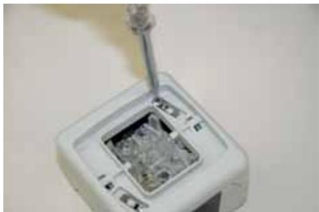
Для крепления и демонтажа лицевой панели нет необходимости выкручивать винт полностью, достаточно повернуть винт на 1 оборот и сдвинуть металлическую пластину.
