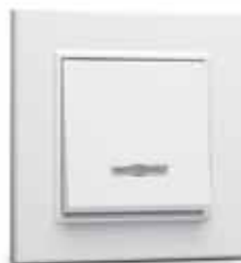
Выключатель одноклавишный* с подсветкой 56001021 10 АХ, 250 V~ EN 60669-1
