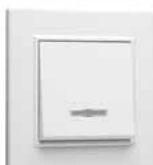
Переключатель проходной* с подсветкой 56001040 10 АХ, 250 V~ EN 60669-1
