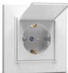
Розетка с крышкой и заземлением * защитой от детей 56001254 16 A, 250 V~ IEC 60884-1
