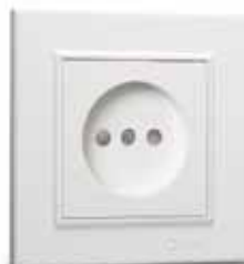
Розетка без заземления с защитой от детей 56001052 16 A, 250 V~ IEC 60884-1
