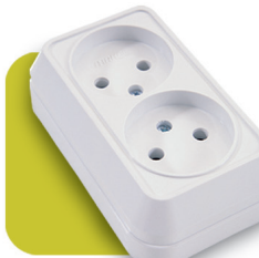
45117 Розетка 2-я без заземления Напряжение 250 V~ Сила тока 16 A Степень защиты IP20
