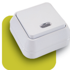
45125 Выключатель одноклавишный проходной с подсветкой Напряжение 250 V~ Сила тока 10 AX Степень защиты IP20
