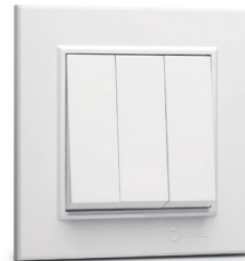
Üçlü Anahtar 3 Tuşlu (3+3) 3 Giriş, 3 Çıkış 3 Gang 3 Pole Switch 56001092 10 AX, 250 V~ EN60669-1
